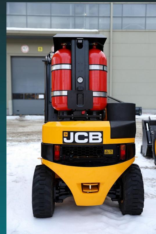
Баллоны для систем пожаротушения со специальной резьбой
